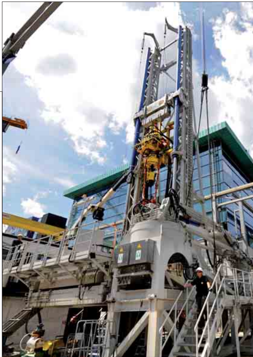
'TECHNOLOGIE EN TOEKOMST': DE PROEFOPSTELLING VAN EEN MODERNE BOORINSTALLATIE OP HET EP RESEARCHCENTRUM VAN SHELL IN RIJSWIJK.
